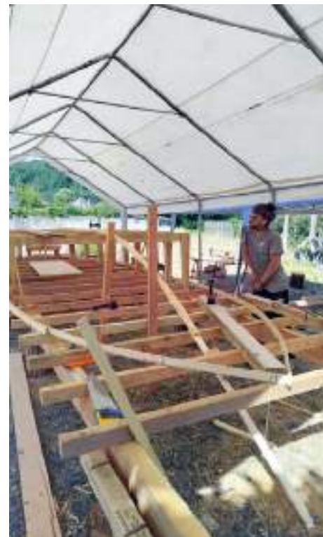
Ce chantier de jeunes à Argentat a pour but la construction d'un gabarot.
