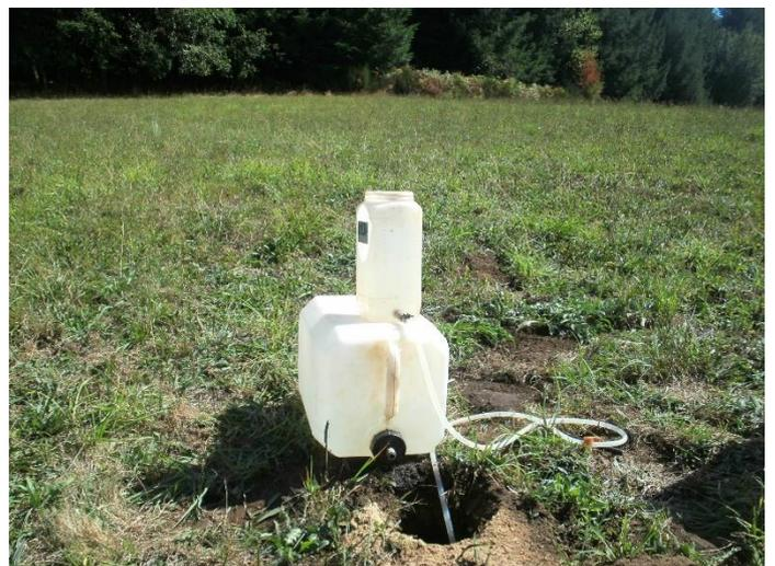
*Figure 6 : Photos test de Porchet-phase de mesures*
