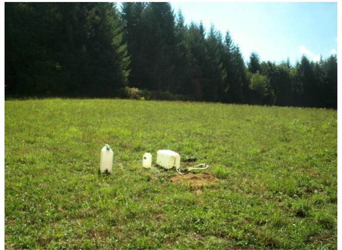
*Figure 5 : Photos test de Porchet-phase de saturation*
