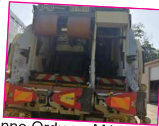
Benne Ordures Ménagères bi-compartmentée 26 tonnes
